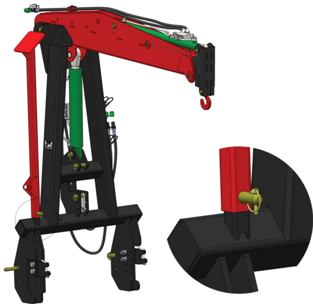
Рис. 7. Транспортное положение погрузчика: опора расположена на раме и закреплена пальцем.
