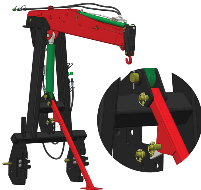
Рис. 8. Положение для хранения погрузчика: погрузчик опирается на опоре и закреплён пальцем.
