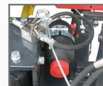
Дополнительно - гидравлический тормоз.
