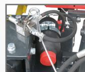
Дополнительно - гидравлический тормоз.
