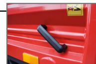
Грузовой кузов с универсальной системой открывания бортов.
