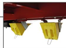
2 упора для колес размещены в оцинкованных карманах.
