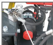
Дополнительно - гидравлический тормоз.
