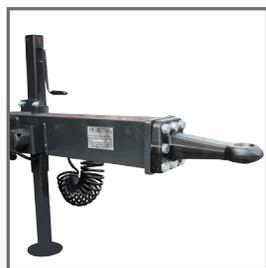
Механическая опорная пятя дышла.
