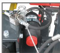
Дополнительно - гидравлический тормоз.
