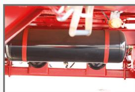
Пневматическая двухпроводная тормозная система.
