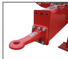
Устройство имеет возможность выбора положения дышла – 480 мм или 590 мм.
