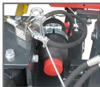
Дополнительно - гидравлический тормоз.
