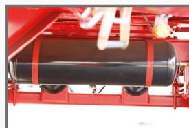
Пневматическая двухпроводная тормозная система.
