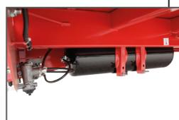
Двухпроводной пневматический тормоз.
