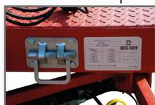
Два устройства с соединительной защелкой для намотки ремней или тросов, защищающих груз.
