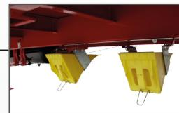
2 упора для колес размещены в оцинкованных карманах.
