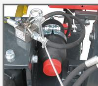
Дополнительно - гидравлический тормоз.
