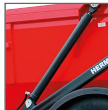
Отклонение кузова вызывают два гидроцилиндра.
