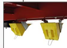
2 упора для колес размещены в оцинкованных карманах.
