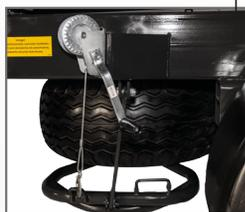
Заднее опрокидывание под максимальным углом 35°.
