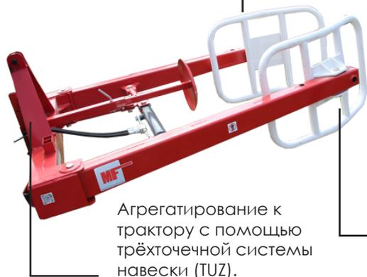
Агрегатирование к трактору с помощью трёхточечной системы навески (TUZ).
