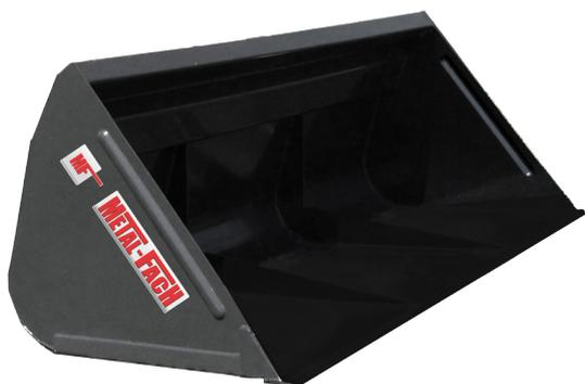
Солидно выполненные ковши для сыпучих материалов, с рабочей шириной 1,2 м – 2,4 м имеют жесткую конструкцию, усиленную благодаря дополнительным ребрам по центру, боковые сгибы и продольную укрепляющую балку. Особое внимание было уделено точности изготовления лемеха. Лемех изготовлен из материала, стойкого к истиранию. Возможность крепления EURO/SMS. Прочное порошковое лаковое покрытие.
