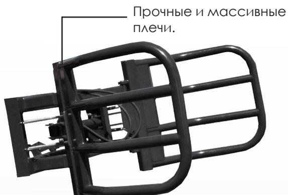
Захват для рулонов предназначен для транспортировки рулонов соломы, сена, силоса. Имеет один привод. Плечи закреплены плавающим способом, это означает, что процесс закрытия и открытия плеч происходит с разной скоростью, что позволяет захвату выезжать из штабеля рулонов без повреждения рулона, находящегося рядом. Более массивная конструкция предназначена для работы в сложных условиях с более тяжелыми рулонами.
