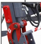
Основная рама (стрелы) изготовлена из листового металла (4 мм). Соответствующий вид мелкозернистой стали и форма профилей стрелы обеспечивают максимальную прочность и низкий вес. Конструкция рамы обеспечивает оптимальную видимость с места водителя трактора.
