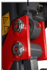
Основная рама (стрелы) изготовлена из листового металла (5 мм). Соответствующий вид мелкозернистой стали и форма профилей стрелы обеспечивает максимальную прочность и низкий вес. Конструкция рамы обеспечивает оптимальную видимость с места водителя трактора.
