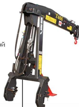
Приспособлен к работе с трактором класса 2 и 3 категории подвески ТУЗ (трехточечная система навески).
