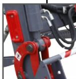
Основная рама (стрелы) изготовлена из листового металла (4 мм). Соответствующий вид мелкозернистой стали и форма профилей стрелы обеспечивает максимальную прочность и низкий вес. Конструкция рамы обеспечивает оптимальную видимость с места водителя трактора.
