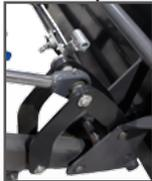
Основная рама (стрелы) изготовлена из листового металла, соответственно 3 мм - T812/2 и 4 мм - T812/1. Соответствующий вид мелкозернистой стали и форма профилей стрелы обеспечивает максимальную прочность и низкий вес. Конструкция рамы обеспечивает оптимальную видимость с места водителя трактора.
