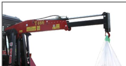
Плечо, выдвигаемое на длину 800 мм.
