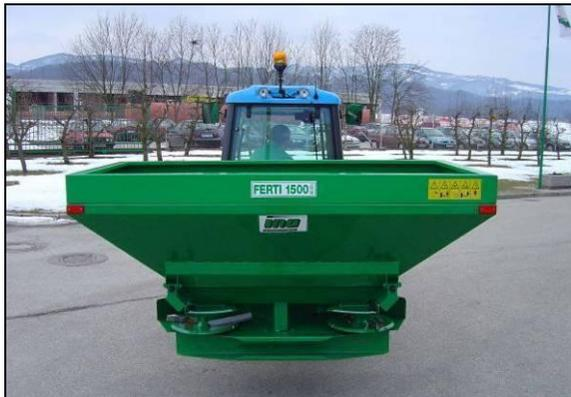
Задним ходом на тракторе приблизьтесь к агрегату так, чтобы нижние рычаги трактора оказались вровень с двумя нижними точками трехточечной сцепки агрегата, и можно было легко вставить штифты, закрепленные шплинтами. Верхний рычаг трактора установите на такую длину, чтобы агрегат во время работы находился в горизонтальном положении, вставьте штифт и закрепите его шплинтом. Боковые стабилизаторы тракторных рычагов установите так, чтобы боковое перемещение агрегата было ограничено.
