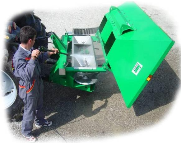
Конструктивное исполнение агрегата позволяет ему опрокидываться назад (рис. 28), что позволяет основательно очистить дно и остальные части разбрасывателя (рис. 29).
