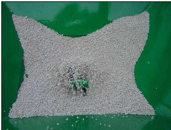
Наполняемый резервуар в нижней части выполнен из двух конусов, для облегчения дозирования. На дне каждого конуса находятся смесиватели (рис. 6), дозирующие удобрение (рис.7) через окно запирающей перегородки и гарантирующие одинаковый приток удобрений на каждый из разбрасывающих дисков. Форма смесивателя позволяет раздробить возможные крупные комки искусственных удобрений. Настройка дозировки удобрений выполняется при помощи рукоятки, находящиеся сзади над разбрасывающими дисками.
