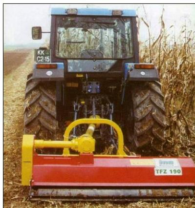
Скорость мульчирования зависит от условий труда и материала, который измельчаем. Оптимальная скорость составляет от 3 до 8 км/ч. В случае измельчения более густой массы необходимо рабочую скорость уменьшить во избежание проскальзывания ремней ременной передачи.
