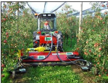
Скорость мульчирования зависит от условий труда и материала, который измельчаем. Оптимальная скорость составляет от 3 до 8 км/ч. В случае измельчения более густой массы необходимо рабочую скорость уменьшить во избежание проскальзывания ремней ременной передачи.
