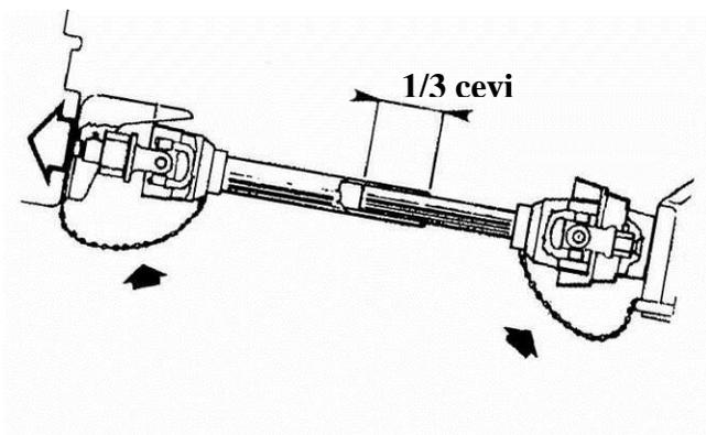
*Рис. 13: Определение соответствующей длины защитного кожуха*
